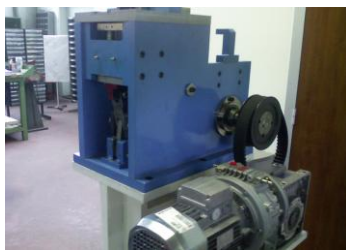
Gr. 11 Dettaglio pressa meccanica alimentata a dischi
