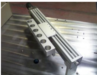
Magazzino dischi automatico
