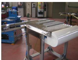
Foto magazzino di scarico
